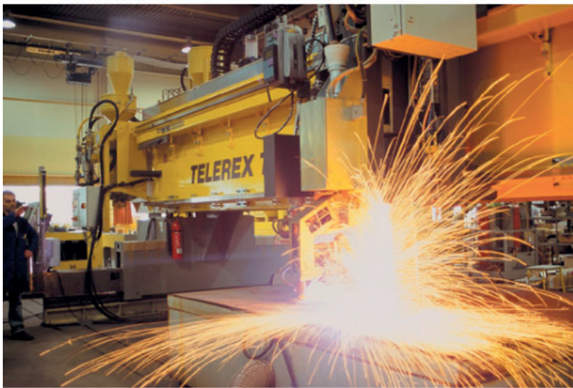
Die Telerec Panelmaschine mit bis zu 33 Metern Spurbreite wird in allen führenden Werften verwendet
